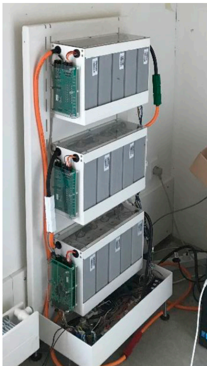
Figur 13 Eksempel på et 5 kWh Batterilager bestående af 15 celler. Til højre en 10 kWh væghængt batteripakke fra Tesla [Teknologisk Institut]
