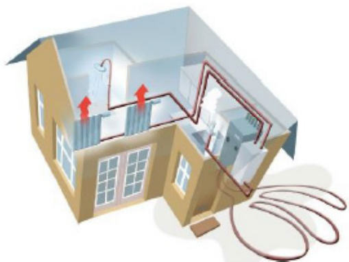
Væske-vand varmepumpe (jordvarme)
